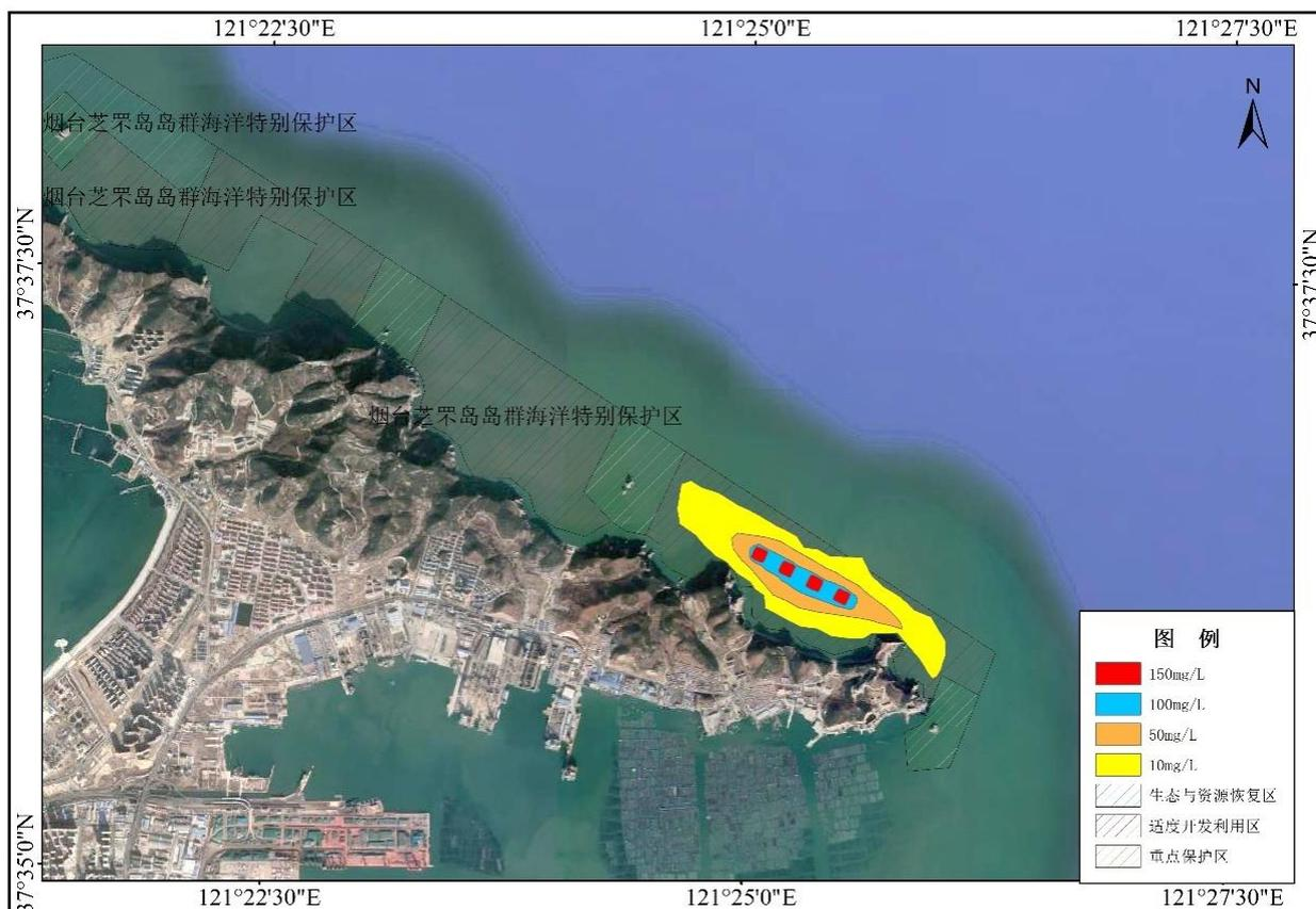
图 43 悬沙扩散最大包络范围示意图
