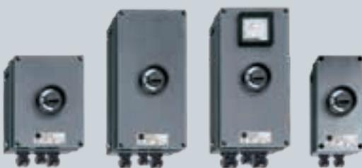
Die Leistungsschalter für den Motorschutz der Reihe 8146/5-V27 von R. STAHL schützen Ex e- und Ex d-Motoren sowie die dazugehörigen Leitungen und Anlagen. Die Standardvarianten sind mit einem einstellbaren, phasenempfindlichen thermischen Überstromauslöser oder einem elektromagnetischen Schnellauslöser ausgestattet, die direkt bei der Bestellung angegeben werden müssen. Der weite Einstellbereich ist für die Verwendung in vielen Motorsteuerungen optimiert.
