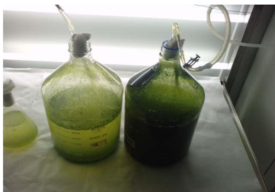
Figura 12. Instalación utilizada para el cultivo de microalgas localizada en el laboratorio de Bioquímica y Biología Molecular de la Universidad de Huelva. La foto corresponde a cultivos realizados en condiciones fotoautótrofas.
