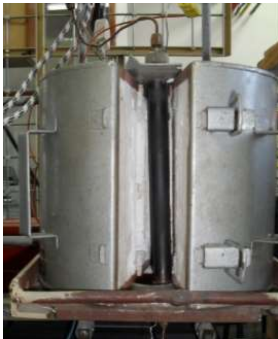
Figura N° 5.1: Reactor de acero inoxidable
