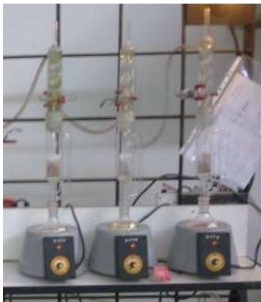
Figura N° 2.8: Montado equipos de Soxhlet en paralelo
