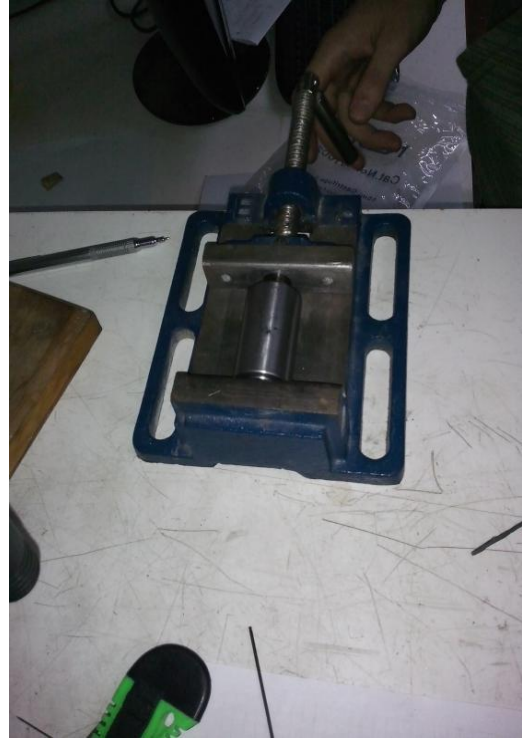
Ilustración 59: Ayuda manual para el desmolde
