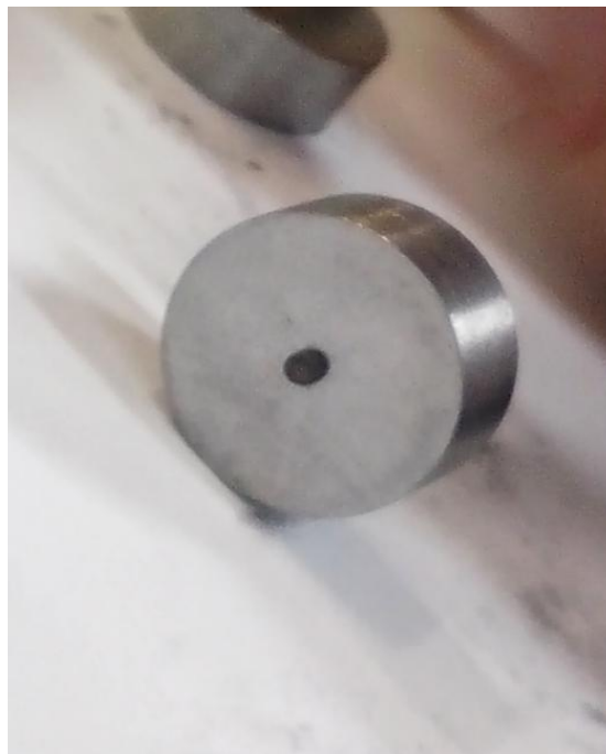
Ilustración 60: Desmolde de la pieza en verde
