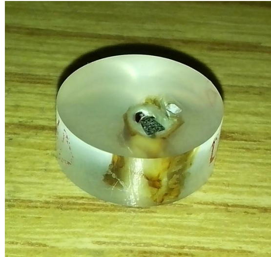
Ilustración 24: Muestras desbastadas y pulidas Ilustración 25: Muestra de 14mm diám. x 6mm alto
