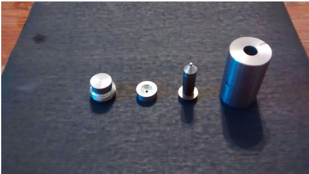
Ilustración 11: Matriz con sus cuatro partes.
