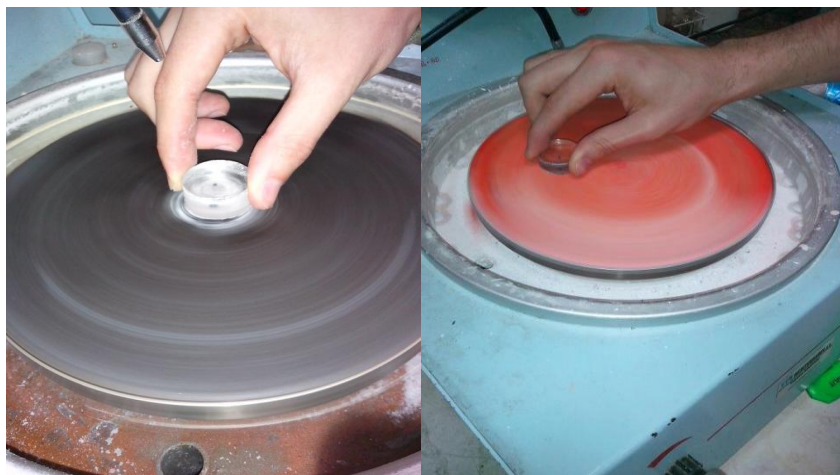
Ilustración 18: Pulido de muestra para Metalografía
