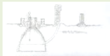
Schizzo esemplificativo del sistema di canalizzazione, raccolta e conservazione delle acque meteoriche in un'area salentina (elaborazione grafica di Michela Abati)
