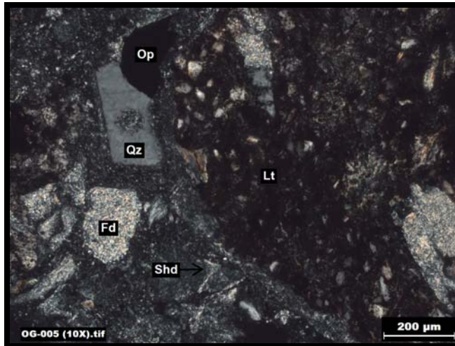
Fotografía No. 2-. OG-005. Toba Vítreo, textura vítrofírica, alotriomórfica equigranular. Aumento 10X. Nícoles cruzados. Cristales anhedrales a subhedrales de Feldespato alterado (Fd), Minerales Opacos (Op), Cuarzo (Qz). Lítico volcánico (Lt) y shard sericitizado (Shd).
