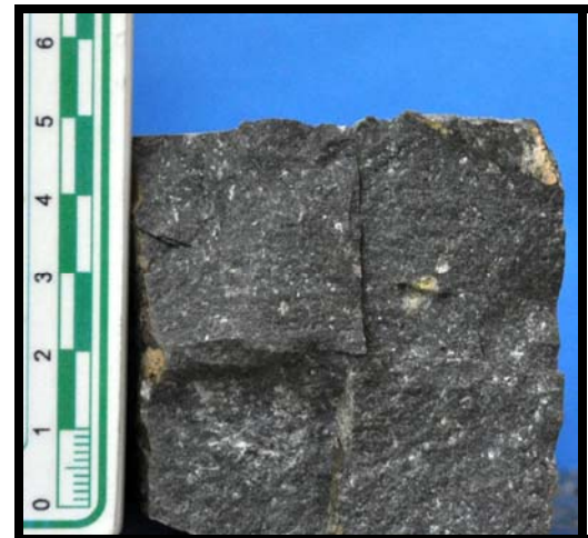
Fotografía No.1. OG -082. (Roca ígnea efusiva)
