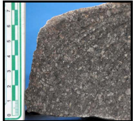
Fotografía No.1. JJPP -137. (Roca ígnea efusiva)
