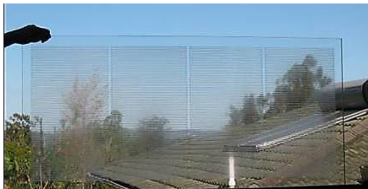
Figura 48: SINAI de persiana de luz con paneles cortados con láser. Vista de una placa de acrílico, W=6\text{mm} , D=4\text{mm} , y en total el módulo rectangular es de 10\text{mm} . Fuente: [A78]
