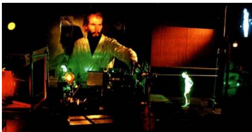
Figura 17: Diagrama geométrico de la Difracción holográfico. Diagrama de una estatuilla, cuando posteriormente se ilumina con luz láser la placa de vidrio, la estatuilla aparece en forma de imagen tridimensional. Fuente: [50]
