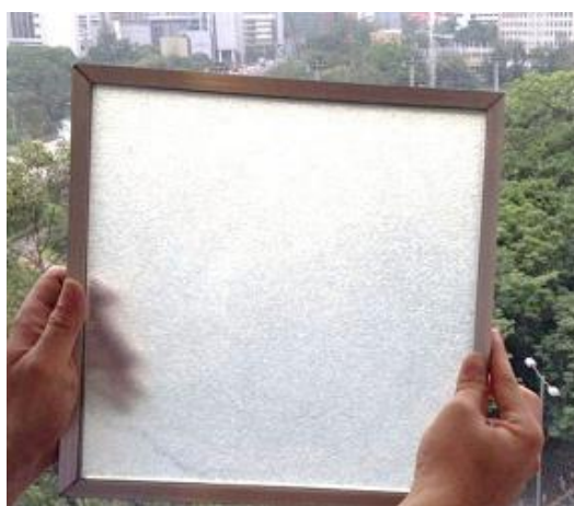
Figura 52: Izquierda: Módulo de ventana con Acristalamiento con Aero-gel de Silicio. Fuente: [91]
