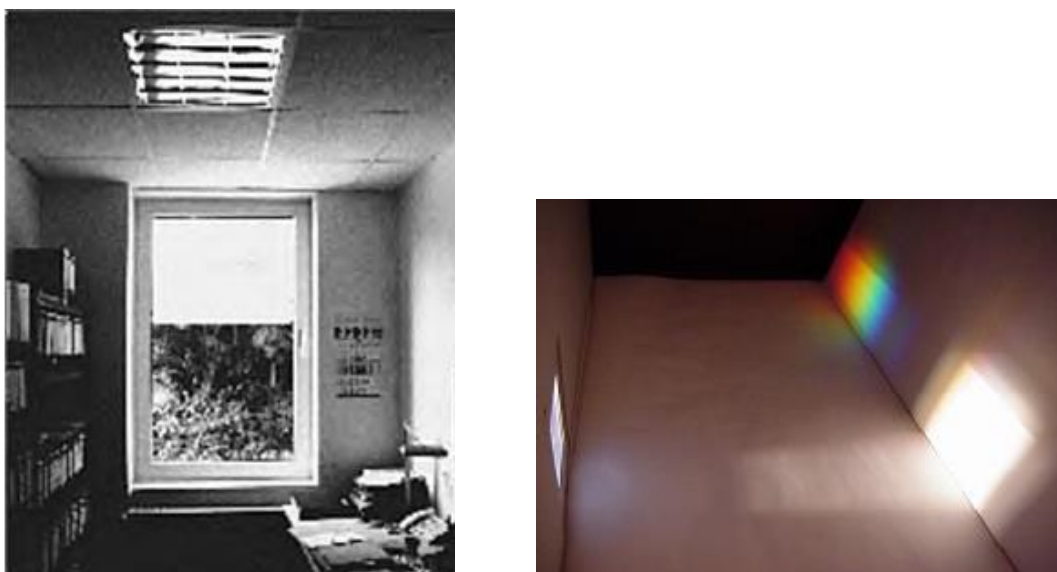
Figura 49: SINAI con Paneles Holográficos. Izquierda: ventana con control de sombras y deslumbramientos al adherir un film holográfico en la parte superior de la ventana. Fuente: [23] Derecha: prueba de un panel vidriado holográfico y la dispersión de colores que ocasiona. Fuente: [105]
