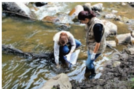
Figura 2.9. Muestreo en campo utilizando red Surber.
