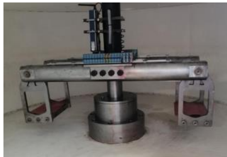
Figura 42. Máquina centrífuga empleada en la modelación física. Fuente propia.
