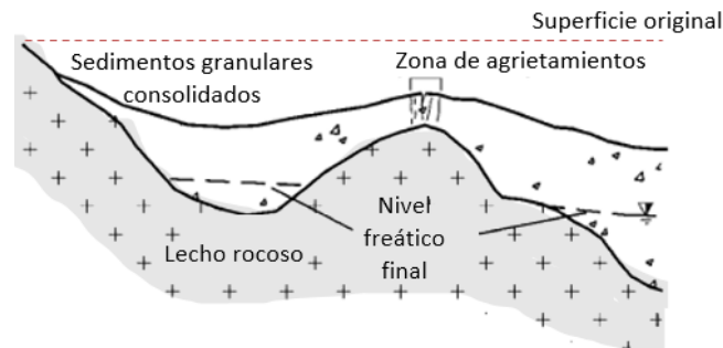
Figura 15. Grietas atribuibles al asentamiento en áreas con estructuras geológicas sepultadas. Adaptado de (Galloway et al., 1999).
