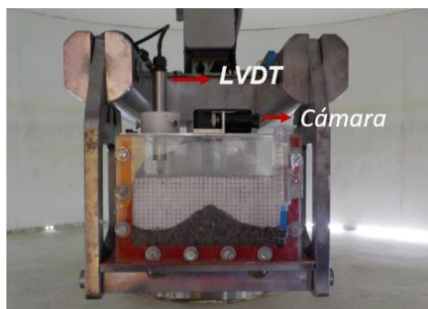
Figura 47. Instalación de la instrumentación en el suelo. Fuente propia.
