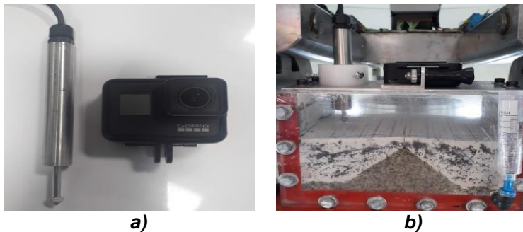
Figura 41. a) Instrumentos utilizados para controlar la deformación del suelo b) montaje de la instrumentación. Fuente propia.
