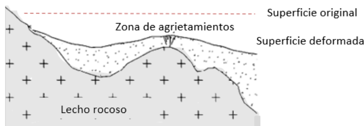
Figura 12. Agrietamiento asociado al asentamiento en zonas de transición abrupta. Adaptado de (Galloway et al., 1999).
