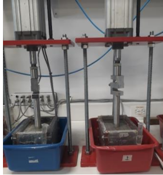
Figura 44. Consolidómetros neumáticos. Fuente propia.
