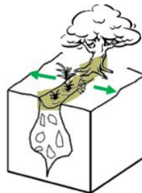
Figura 14. Grietas atribuibles a la vegetación. Adaptado de (Galloway et al., 1999).
