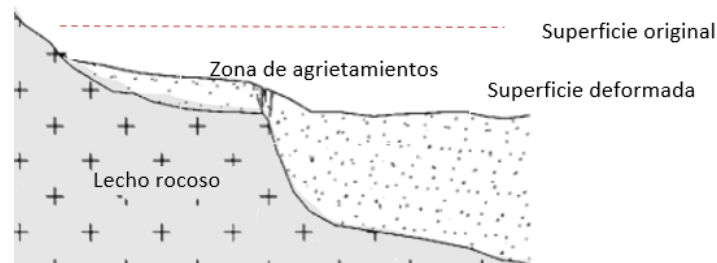
Figura 13. El agrietamiento atribuible al asentamiento en zonas con anomalías estratigráficas. Adaptado de (Galloway et al., 1999).
