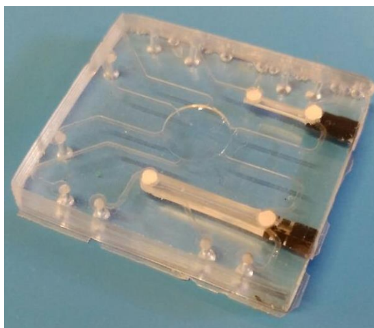
Figura 25. Réplica final de PDMS lista para la producción de radiofármacos PET.
