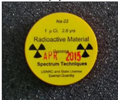
Figura 33. Pastilla compuesta por el radioisótopo Na-22 con tiempo de semivida de 2.6 años.
