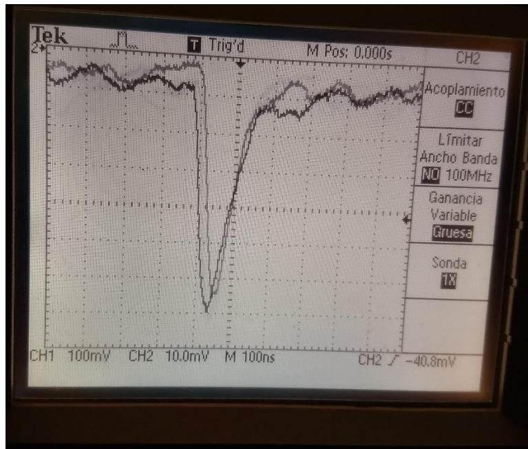
Figura 49. Determinación del límite inferior de los pulsos de salida del TIA.
