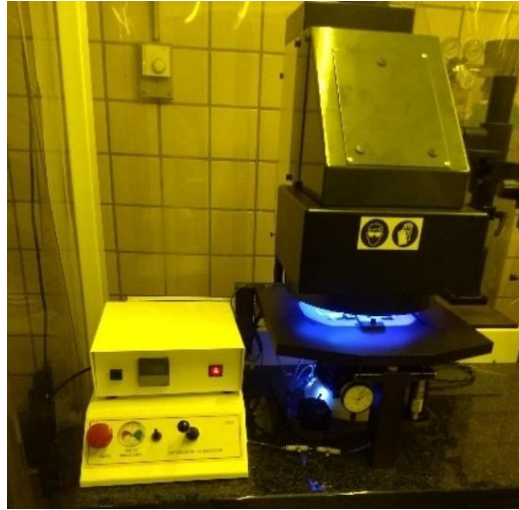
Figura 14. Proceso de exposición de un PCB o SU-8.
