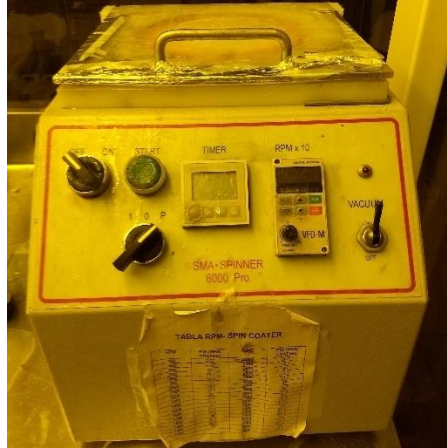
Figura 17. Spincoater utilizado, SMA SPINNER 6000.
