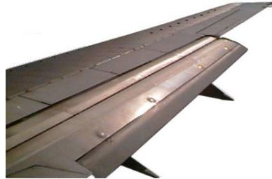
Figura 2.3: Mecanismo hipersustentador de una aeronave.
