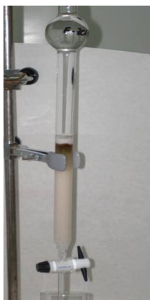
Figura 3.3. Purificación del extracto mediante separación cromatográfica en una columna de sílice ácida modificada.
