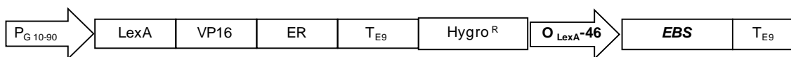
Figura 1. Esquema del vector inducible por \beta -estradiol pMDC7. Esquema de la estructura del vector de clonación inducible por estrógeno pMDC7, derivado del plásmido PER8, compatible con el sistema Gateway.
