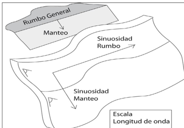
Figura 4.40: Esquema de ondulación. Es necesario notar que para simplificar la medición este debe ser hecho sobre un plano horizontal
