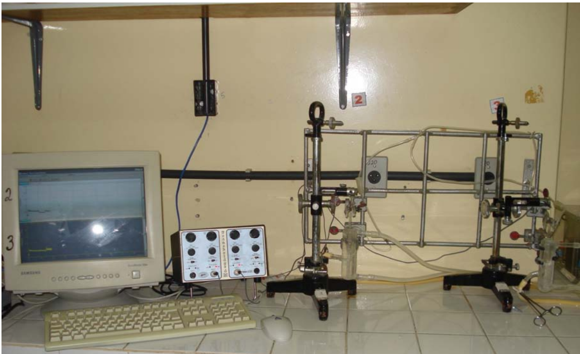
Figura 3 – (A) espectrofotômetro Ultraspec 1100 pro; (B) sistema para o registro das contrações isotônicas composto por cuba para banho de órgãos isolados, alavanca de inscrição frontal e cilindro esfumado de um quimógrafo e (C) sistema para o registro das contrações isométricas composto por cuba, transdutor de força, amplificador e sistema de aquisição digital.
