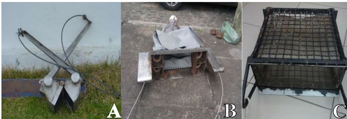
Figura 11 - Amostradores de fundo empregados na coleta de sedimento no litoral sul de Pernambuco. A - Van Veen; B – Draga 1; C – Draga 2.
