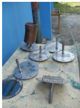
Fig.72.- Platos de acero inoxidable y serpentines de cobre de 3/8".
