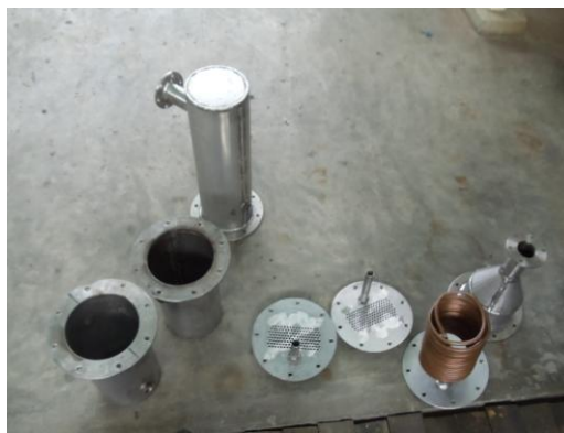
Fig.71.- Cuerpos de la columna, platos y cabeza de la columna de destilación.
