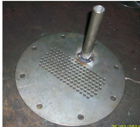
Fig. 57.- Construcción del plato de acero inoxidable.
