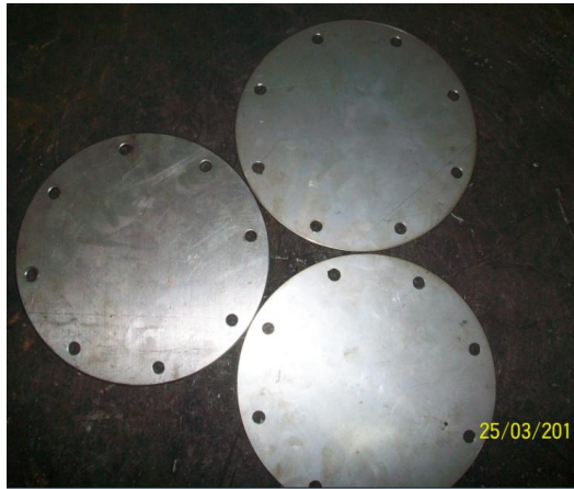
Fig. 56.- Corte de los platos de la plancha de acero inoxidable de 2mm.
