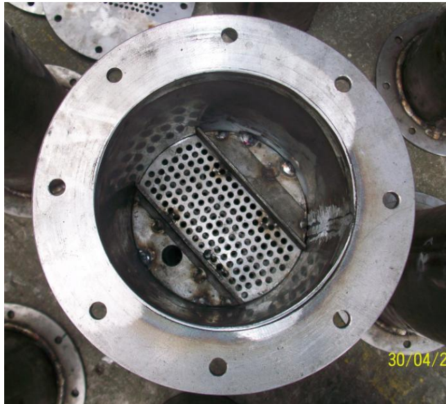
Fig. 60.- Plato colocado en el interior del cuerpo.
