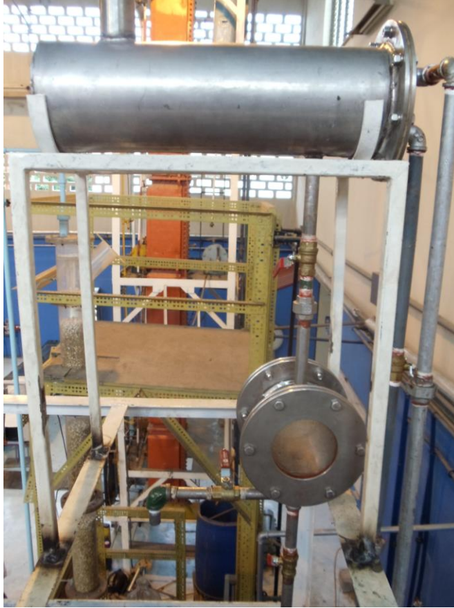
Fig. 66.- Condensador Total con visor en la parte inferior.
