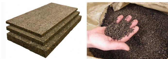
Figura 4.12 Aglomerado de cortiça expandida (esquerda) e granulado de cortiça (direita) - [33]
