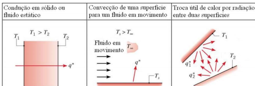
Figura 2.1 – Mecanismos de transferência de calor – adaptado de [6]
