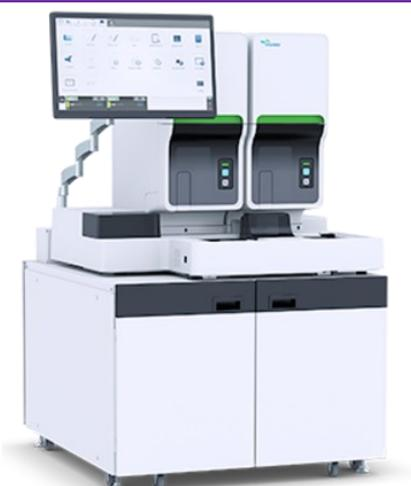
*Figura 29 - Equipamento Sysmex XN-2000 da casa comercial Sysmex, que realiza a análise da fração eritrocitária, leucocitária e plaquetária.*
