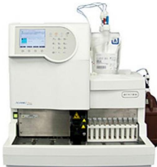
*Figura 34 - Equipamento Adams A1c HA-8180T da ARKRAY utilizado no estudo da hemoglobina glicada e outras variantes de hemoglobina.*
