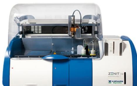
*Figura 12 - Equipamento Zenit RA responsável pela deteção de autoanticorpos por quimioluminescência (13).*
