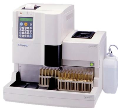
*Figura 5 - Equipamento Aution Max AX-4280®, que permite a análise sumária de urinas.*
