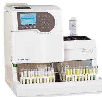
*Figura 7 - Equipamento Aution Max AX-4030® que permite a análise sumária de urinas.*
