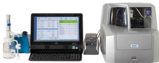
**Figura 48** - Equipamento Finnish mariPOC, da ArcDia, utilizado para deteção antigénica de vírus respiratórios (46).
