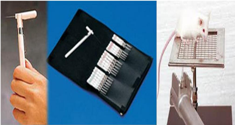
Figura 2. Juego de monofilamentos de von Frey utilizado para inducir estímulos mecánicos en la superficie plantar de las patas traseras de los animales.
