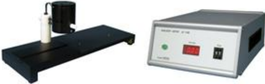
Figura 1. Analgesímetro utilizado para realizar el test de retirada de la cola. Aparato donde se inmoviliza al animal y se cuantifica el tiempo que tarda en retirar su cola cuando se le aplica directamente sobre ella un haz de luz de una intensidad deseada.
