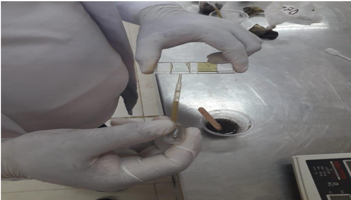
Anexo 5. Llenando una cámara McMaster en la técnica McMaster modificado.
