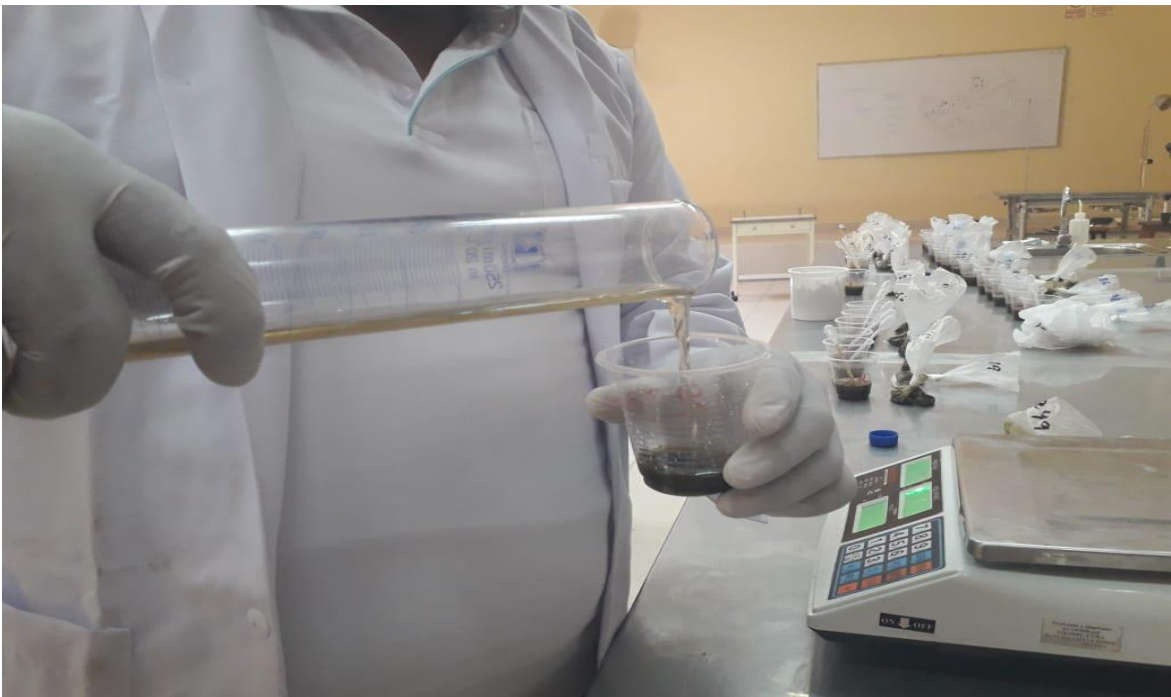
Anexo 8. Colocando la solución de flotación a la solución filtrada.
