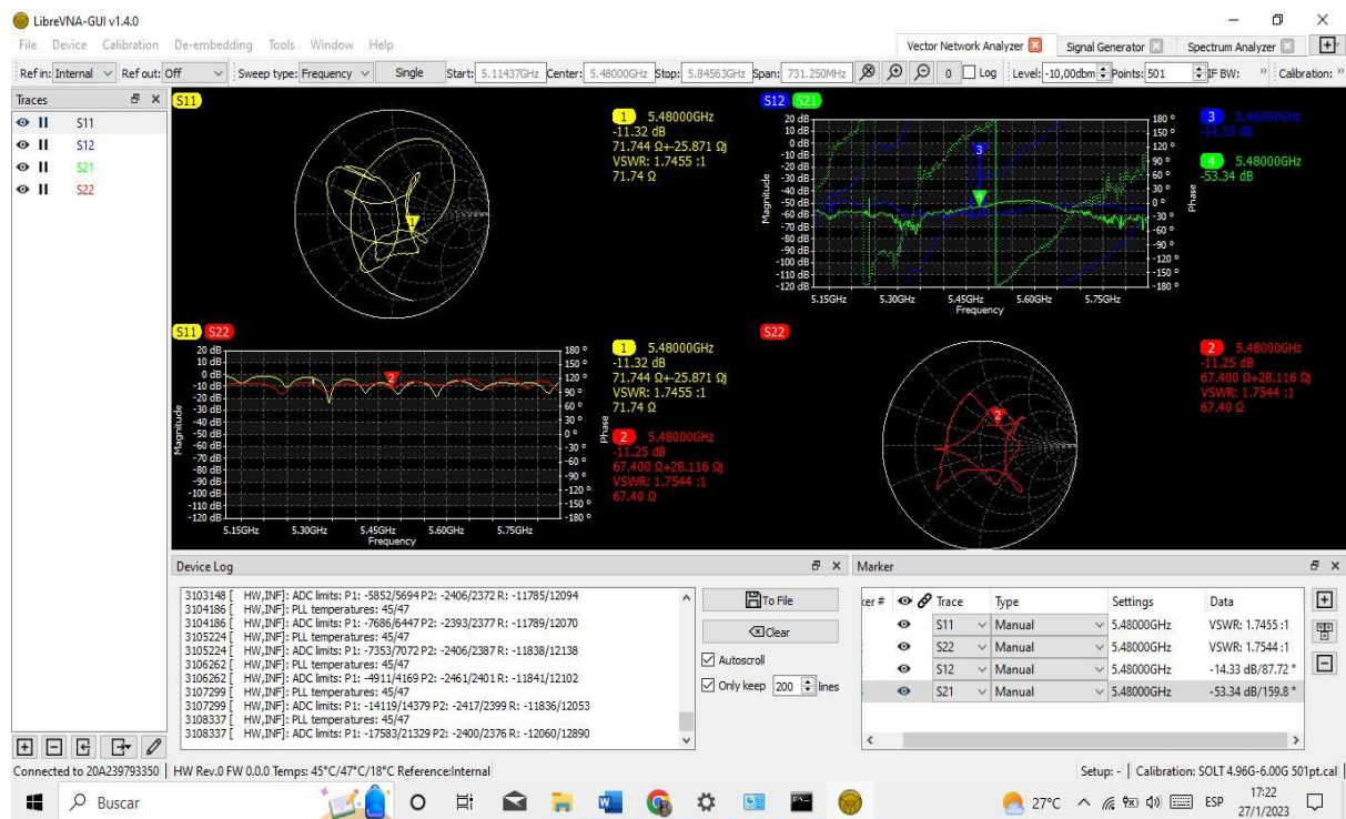
Figura 4.53. Parámetros S de la F5480Ghz obtenidos por medio del VNA.
