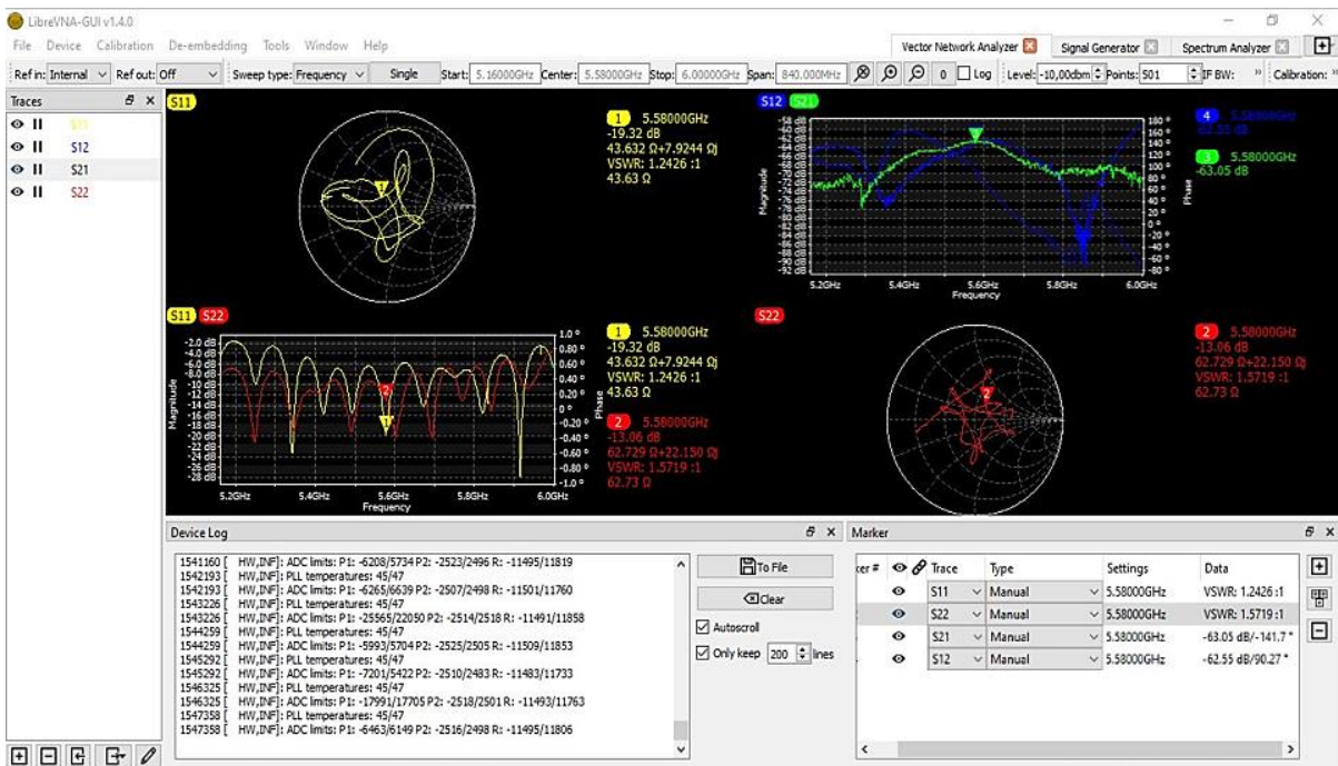
Figura 4.60. Parámetros S11, S21, S12 y S22 – freq: 5580Ghz (segunda prueba).
