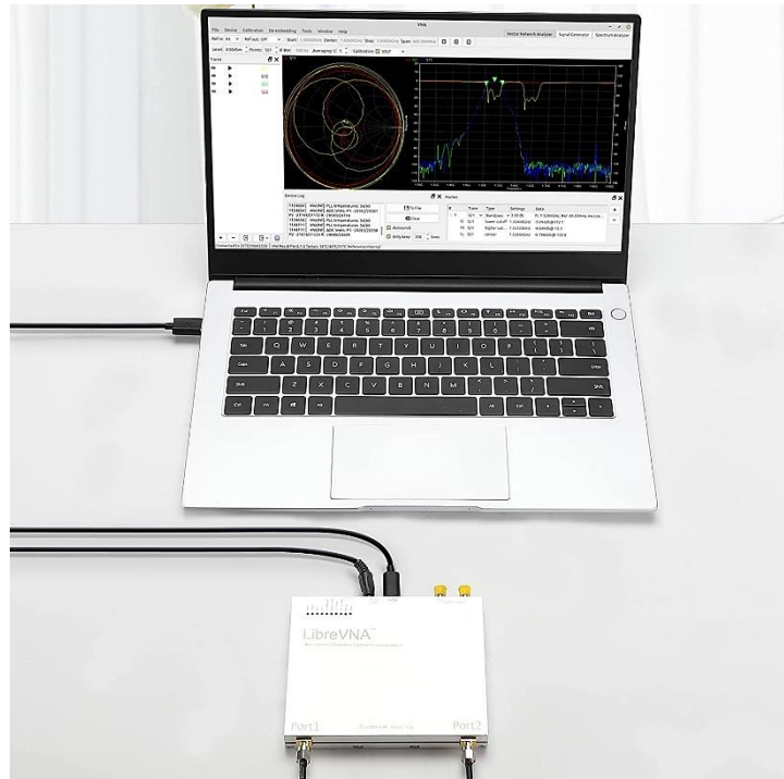
Figura 4.43. Conexión LibreVNA a PC. Fuente: Imagen elaborada por el autor.
