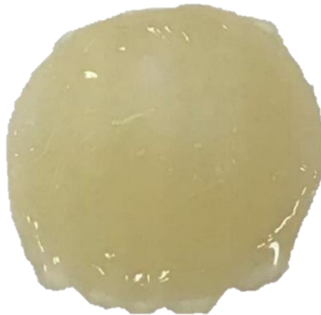
Figura 9. Biofilm de celulosa bacteriana obtenido a partir de medio Hestrin-Schramm en cultivo agitado. Hidrogel con una formación multicapa, el cual contiene residuos y adherencias atrapadas.
