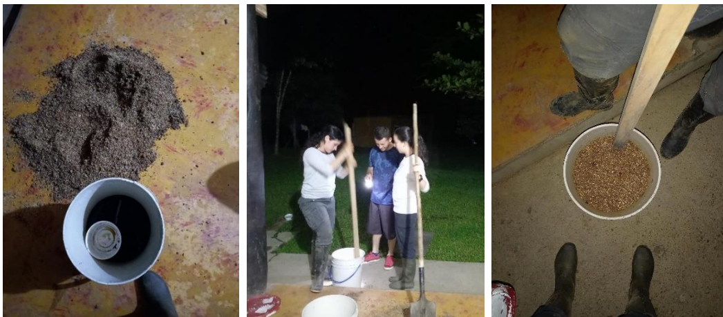
Figura 6. Mezcla y compactación de materiales para comenzar proceso anaeróbico que se extendió durante 20 días.
