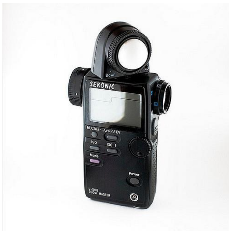
Obrázek 1-13: Expozimetr s funkcí měření dopadajícího světla (bílá polokoule), jasoměru v podobě spotmetru (hledáček napravo).
