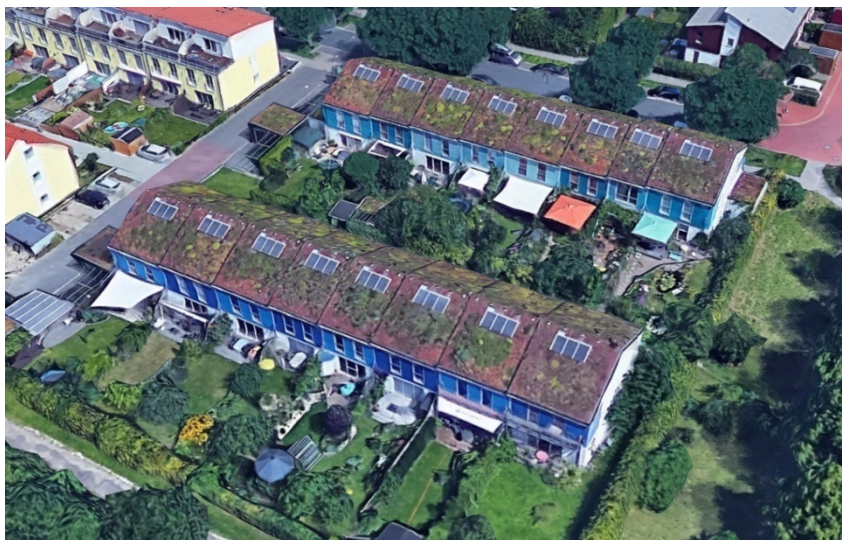
Zabudowa mieszkalna jednorodzinna chłodzona i ogrzewana energią pozyskiwaną ze źródeł odnawialnych. Na zielonych dachach widoczne są zestawy kolektorów słonecznych, zorientowanych na południe
