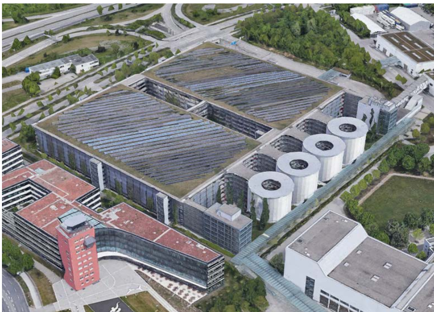
Widok na dach parkingu wielopoziomowego, obsługującego tereny Targów w Monachium. Na dachu parkingu zamontowano dużą instalację fotowoltaiczną. Czytelne jest ukierunkowanie rzędów kolektorów na południe. Zlokalizowane w obszarze północno-wschodnim Messestadt Riem.
