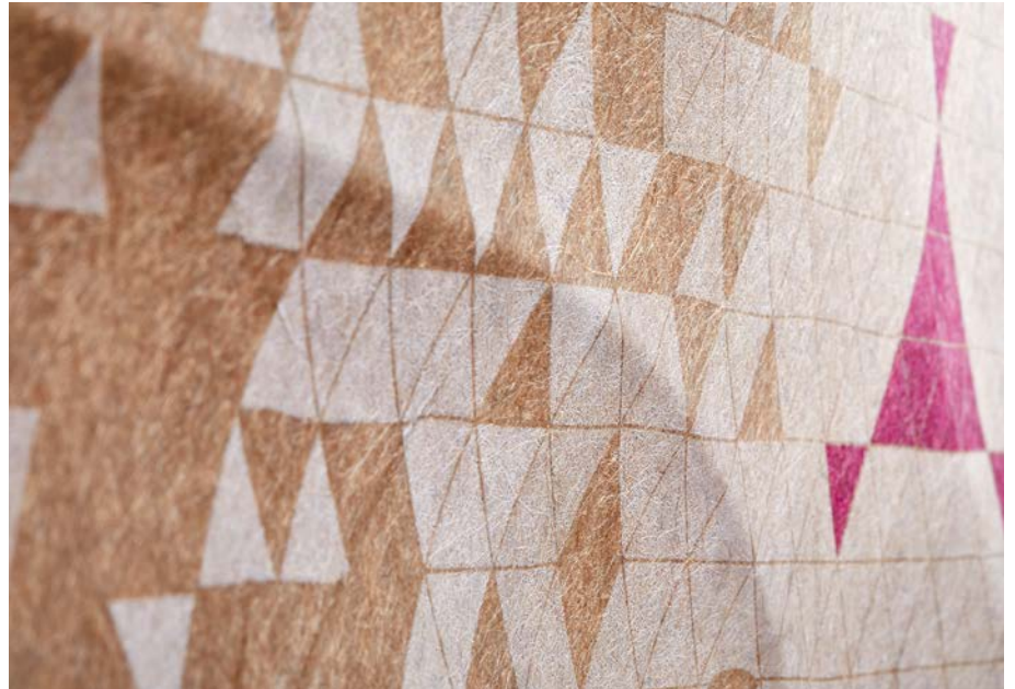
Bild 2. Damit die Naturmaterialien den Anforderungen an die Oberflächen standhalten, werden sie mit einer Schutzfolie laminiert. Die Herausforderung des Prozesses ist die Verformung aller Materialien bei bis zu 200 °C (© YFAI)
