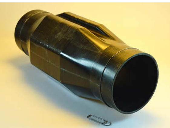
Umformung aus einem Kreisrohr mit 30% Umfangsänderung im Umformbereich: Die Rohrenden wurden nicht umgeformt und zur Abdichtung genutzt. Die Sicke ist vollständig ausgeformt (© TU Darmstadt)
