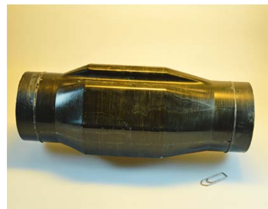
Umformung aus einem Kreisrohr mit 30% Umfangsänderung im Umformbereich: Die Rohrenden wurden nicht umgeformt und zur Abdichtung genutzt. Die Sicke ist vollständig ausgeformt (© TU Darmstadt)
