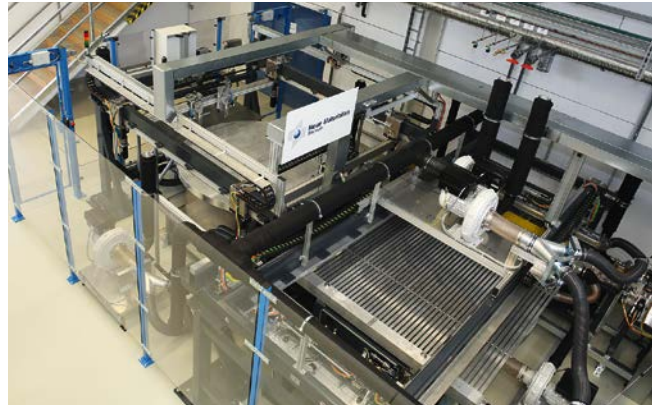
Bild 2. Das Konzept der Multiaxial-Tapelegeanlage sieht zwei Vakuum-Legetische und bis zu vier Materialzuführungen für einen prozessstabilen flexiblen UD-Tape-Gelegeaufbau vor (© NMB)
