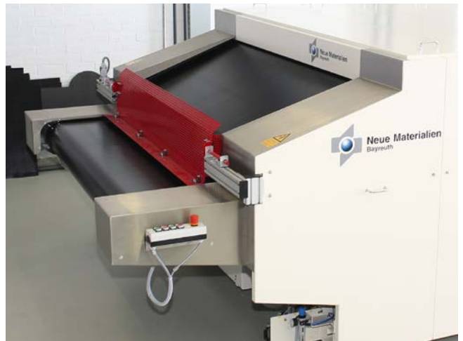
Bild 3. Die Doppelbandpresse mit PTFE-Bändern dient zur Vorkonsolidierung der UD-Tape-Gelegeaufbauten (© NMB)
