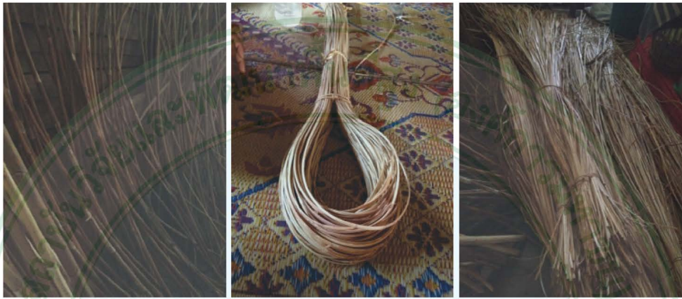
ภาพที่ 29 หวายโครง (ก) หวายอัด (ข) และหวายสาน (ค) ที่ใช้ในการทำเฟอร์นิเจอร์หวายของกลุ่มถักสานเฟอร์นิเจอร์หวายตามพระราชดำริ หมู่บ้านสะปัน จ.น่าน
