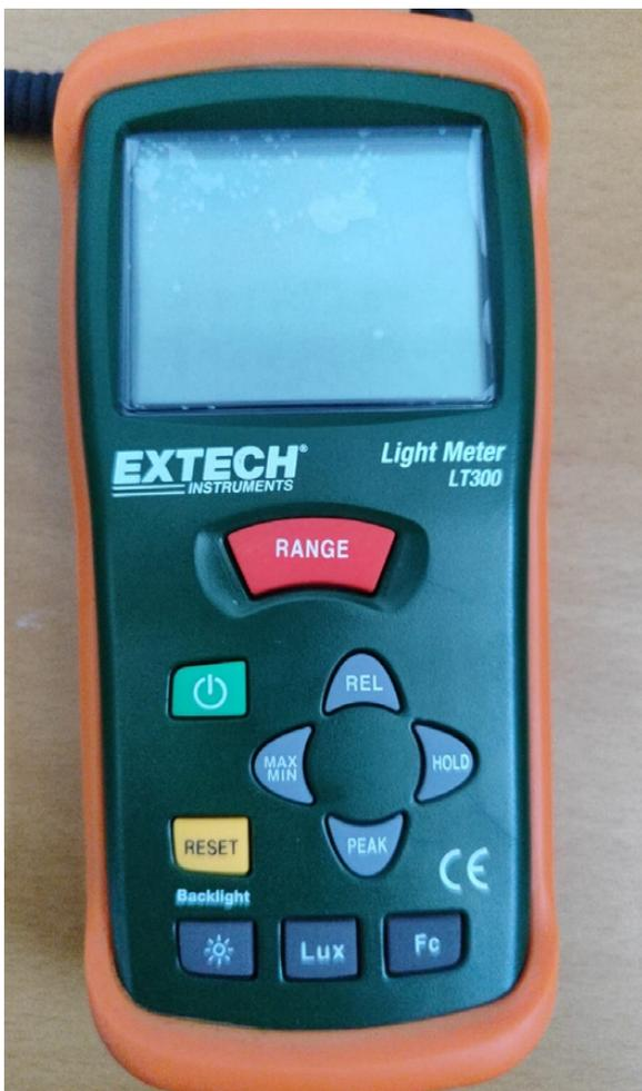
**Figura 2.** Luminómetro digital utilizado en el presente estudio.
