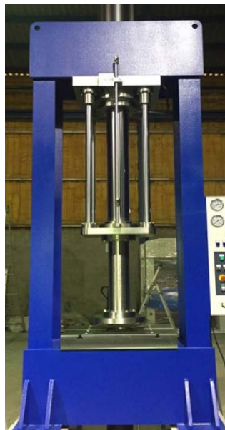
Press with 1.200 mm piston stroke Presse mit 1.200 mm Kolbenhub Presse avec une course de piston de 1.200 mm Prensa con carrera del pistón de 1.200 mm
