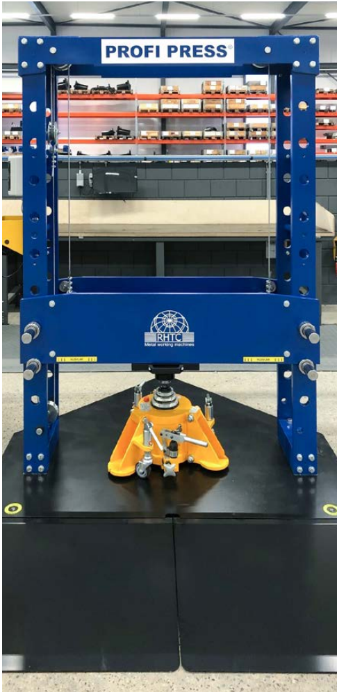
Jack Testers, designed for the Dutch Ministry of Defence Test-Pressen, entwickelt für das niederländische Verteidigungsministerium Testeurs de vérins, conçus pour le ministère néerlandais de la défense Comprobadores de gatos, diseñados para el Ministerio de Defensa holandés
