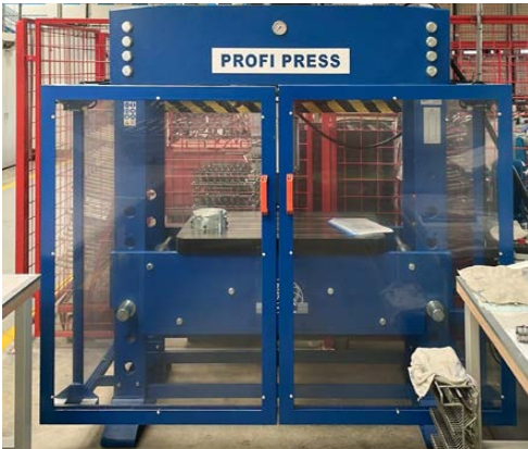
Workshop press with polycarbonate protection screens Werkstattpresse mit Polycarbonat- Schutzgitter Presse d'atelier avec écrans de protection en polycarbonate Prensa de taller con pantallas de protección de policarbonato
