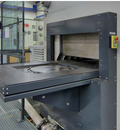
Custom-Made Press (2000 ton) | Kundenspezifische Presse (2000 Tonnen) | Presse Sur Mesure (2000 tonnes) | Prensa a medida (2000 toneladas)
