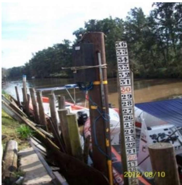
Foto N° 16: Regla de medición de la altura de aguas ubicada sobre el río Luján, utilizado por Prefectura Dique Luján. En esta regla, la altura 2,30 mts. (23) indica alerta y 2,80 mts. (28) indica evacuación.
