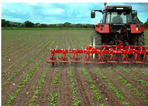
Figur 24. Einböck radrensare för betor och vissa trädgårdsgrödor. Källa: B Liljeholm AB.
