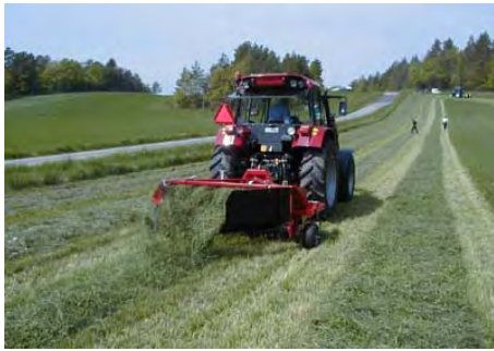
Figur 34. Strängluftare . Votex Teddy, förkortar förtorkningen för ensilage, hö och halm.
