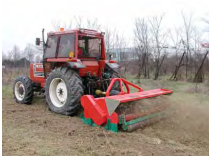
Figur 40. Betesputs , Kverneland FX , för borttagning av gammalt gräs och tuvor.
