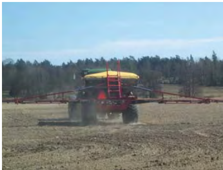
Figur 29. Tive Gödsel-Jet Rampspridare. Kombimaskin för konstgödsel och utsäde.
