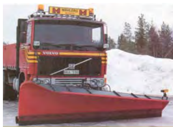
Figur 49. Snöplog , Mählers, på en lastbil. Resultatet blir en ren vägyta.
