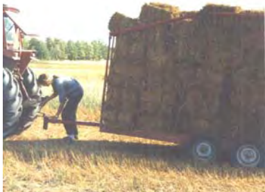
Figur 41. Balvagn , för transport av hård- eller löspressade balar.
