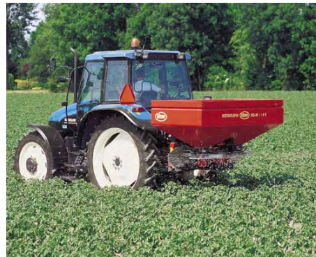
Figur 30. Konstgödelspridare, Vicon RotaFlow, buren för mindre arealer.
