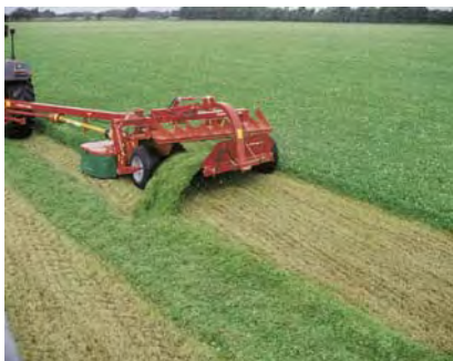
Figur 31. Slåttermaskin Taarup rotorslåtterkross.
