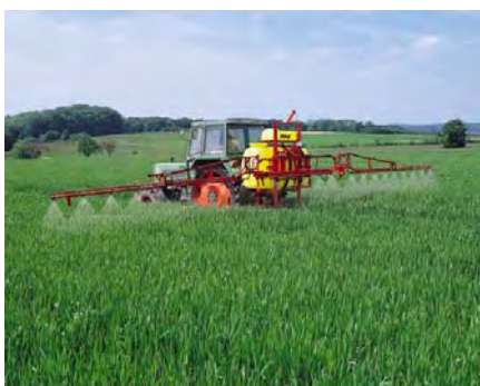
Figur 26. Buren lantbruksspruta Rau. Sprimat L.600 - 800 l och 10 – 18 m ramp.
