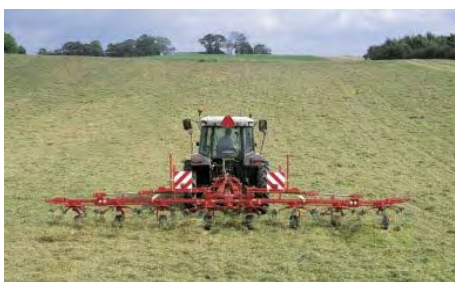
Figur 32. Rotorhövändare , Taarup 8090 med arbetsbredd på 9 m.
