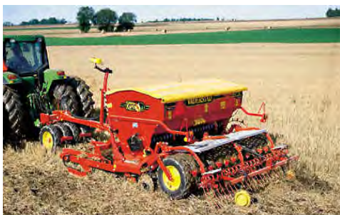
Figur 23. Såmaskin : Väderstads kombisåmaskin Rapid-Super, 4 m bredd är en av de vanligaste.
