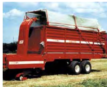
Figur 36. JF hackvagnar kastar materialet direkt upp genom struten i vagnen.
