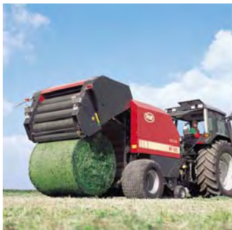
Figur 37. Rundbalspress Vicon RF 135 . Balen måste sedan inplastas om vallen skall användas som ensilage.
