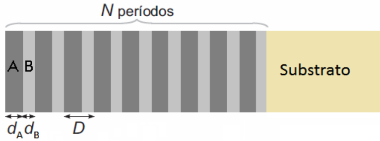
Figura 2.1: Esquema de una superred depositada sobre un sustrato. Los materiales A y B están representados por colores diferentes. Los espesores de las capas de los materiales A y B son d_A y d_B , respectivamente, y su suma es igual a D , el periodo de la superred. N representa el número de periodos de la superred.
