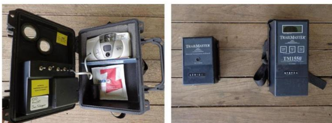
Figura 12. Sistema de activación de cámaras trampa con emisor y receptor de rayo de luz infrarroja. Créditos de imagen: H. Bárcenas. Tomado de: Chávez et al. (2013)
