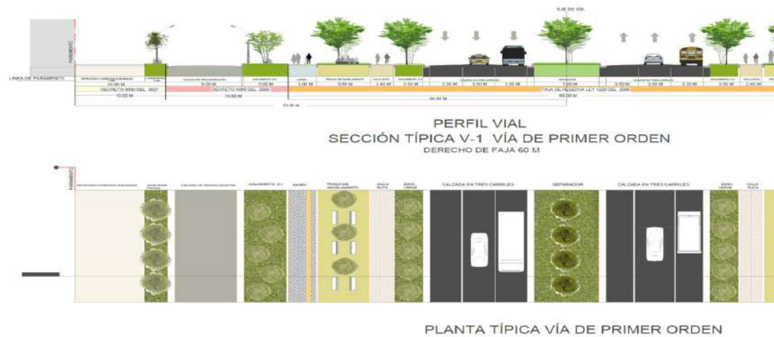
Imagen 59 . Sección definida para las vías de primer orden por parte del municipio de Rionegro.
