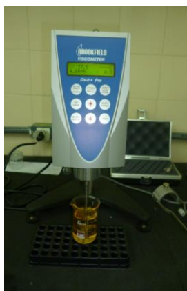
Figura 9. Viscosímetro digital Brookfield do laboratório de Tecnologia farmacêutica da Faculdade de Ciências Farmacêuticas da Universidade Federal do Amazonas.
