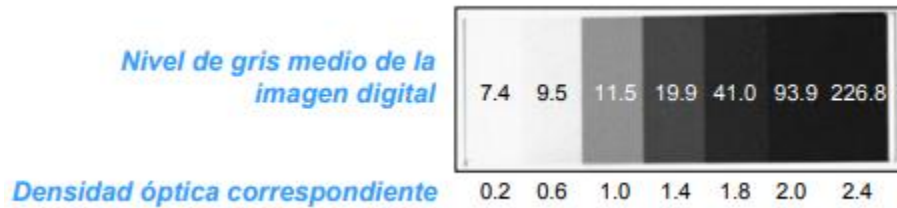
Figura 18. Calibración de densitometría óptica. La figura muestra los valores utilizados para generar la curva de calibración en el software ImageJ, con la que se analizaron las fotografías digitales de atrociitos para el cálculo de la OD.
