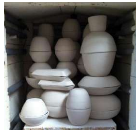
Fig. 5 Piezas de pequeño formato, en porcelana, técnica colada directa, preparadas en el horno para una cocción de bizcocho. 2011.
