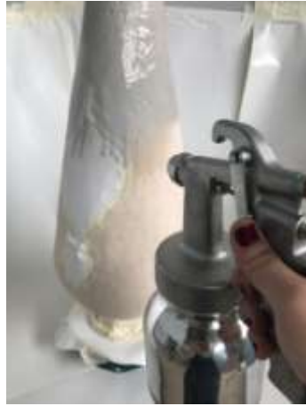
Fig. 47 aplicación de un vidriado con pistola Pieza VI.
