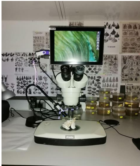
Figura 3. Lupa MOTIC. Preparada con luz ultravioleta y muestra enfocada.
