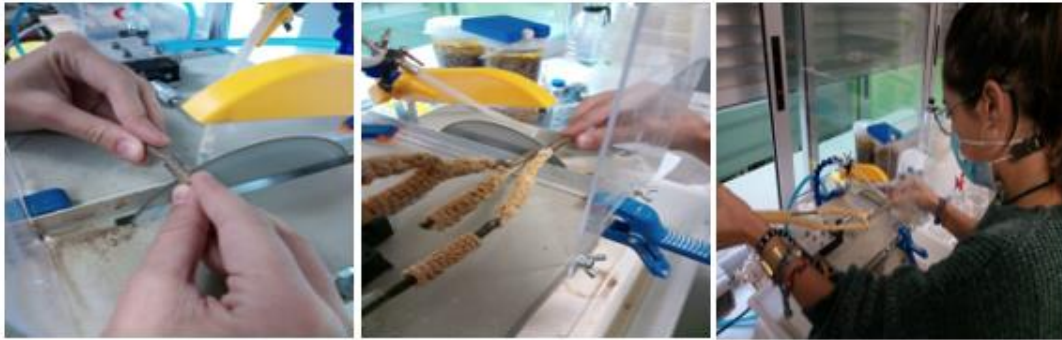
Figura 2. Imágenes correspondientes a los tres cortes de la parte basal, con el uso de la minimesa de corte YXEC.
