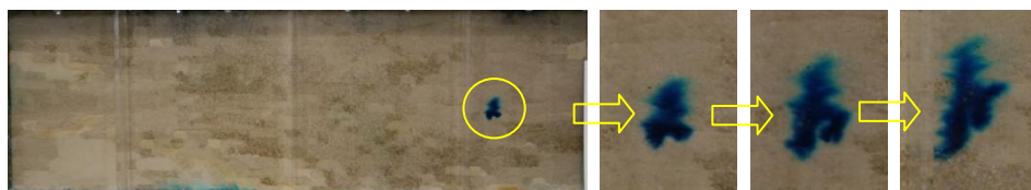
Figura 42. Inestabilidades gravitatorias observadas en el ensayo experimental posterior a la inyección del trazador para 55 min, 58 min, 1.82 h y 2.92 h respectivamente.
