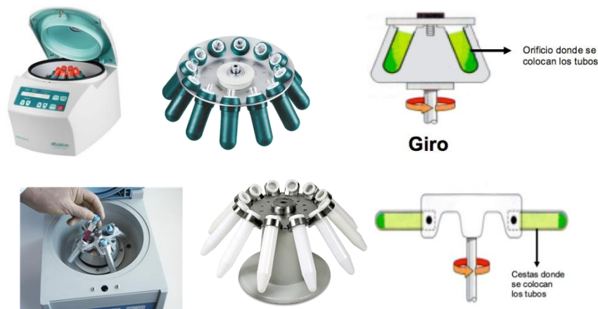
Figura 2. Fila superior: centrífuga de rotor angular, elementos y posición de los tubos durante el giro. Fila inferior: centrífuga de rotor basculante, elementos y posición de los tubos.
