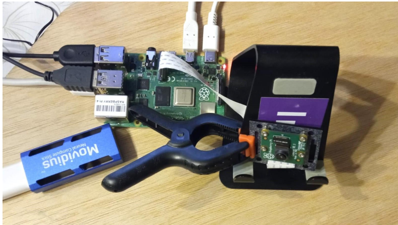
Figura 23. Raspberry pi 4B, PiCam, y procesador Intel Movidius, Irene Sánchez, 2022
