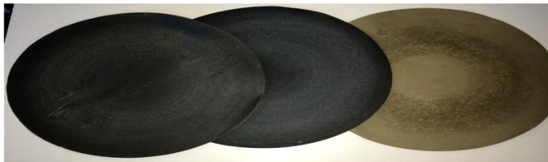
Figura 17: Papel de SiC de granulometrías de izquierda a derecha: 500, 1000 y 4000.
