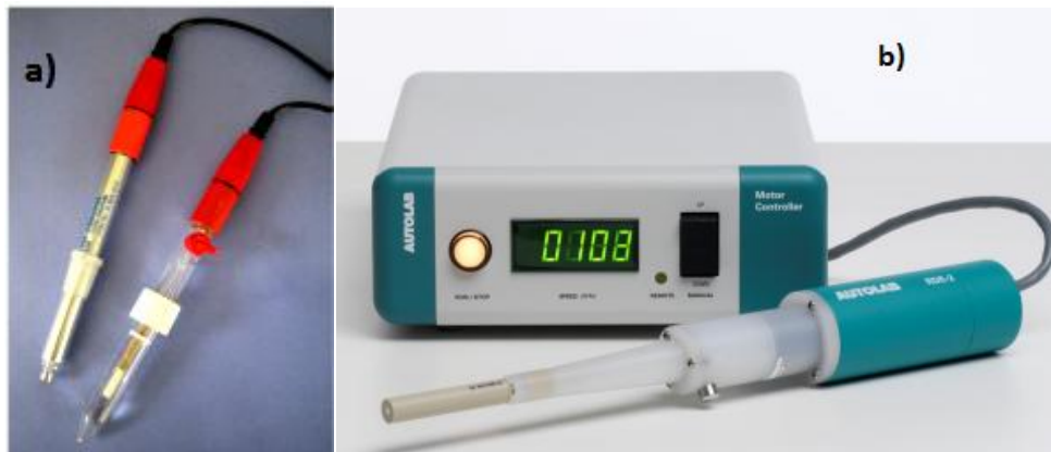
Figura 20: En la fotografía a) el electrodo de la izquierda es el contraelectrodo de Pt y el de la derecha es el electrodo de referencia de Ag/AgCl, mientras que en la figura b) está el RDE. [71]
