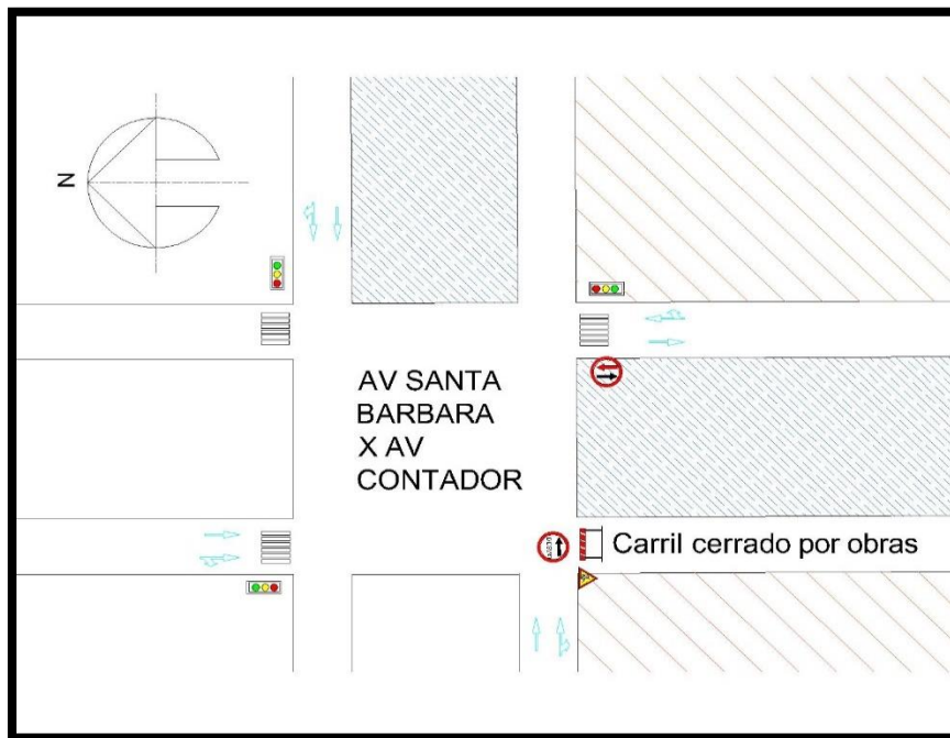
Ilustración 44 Señalización de obra
