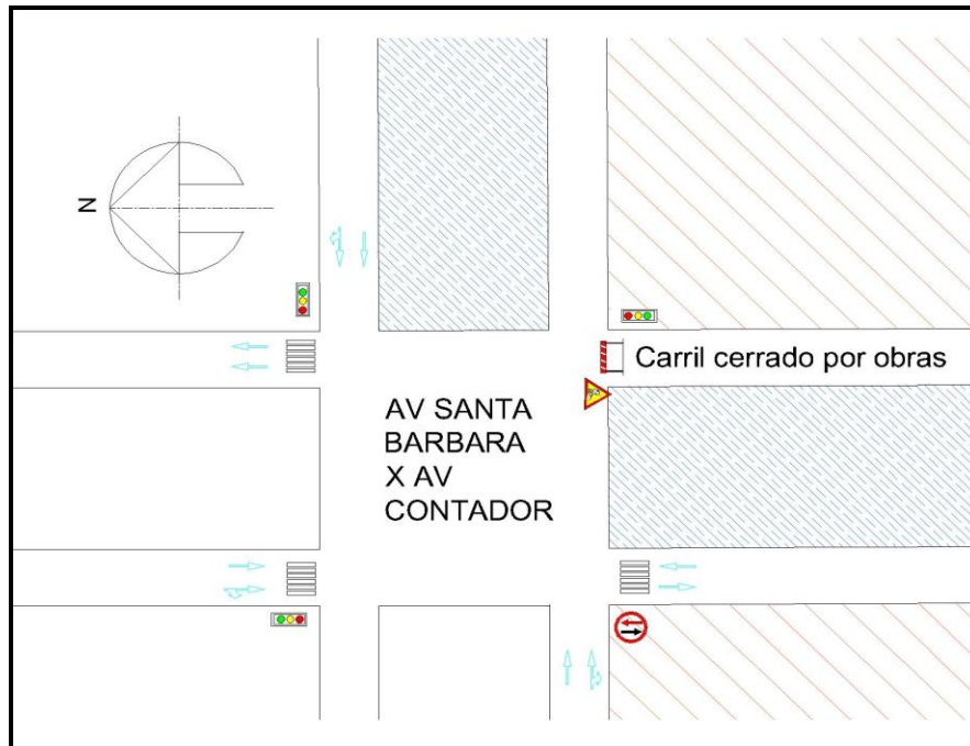
Ilustración 46 Señalización de obra
