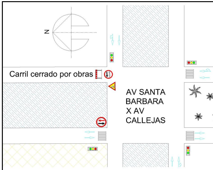
Ilustración 45 Señalización de obra
