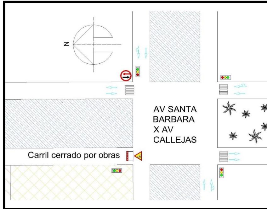
Ilustración 43 Señalización de obra
