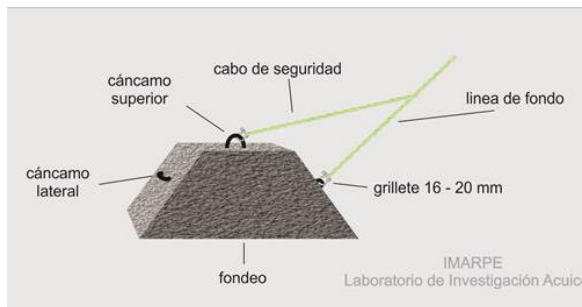
Figura 26. Detalle del sistema de anclaje o fondeo del Long line
