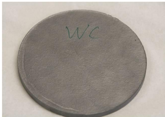
Abbildung 1: Wolfram – Carbid – Probe
