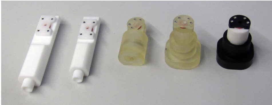
Abbildung 2: Entwicklungsserie der Erprobungsmuster für den wiederverwendbaren Cell-Mixer. Die beiden frühen Muster links wurden komplett aus Teflon gefertigt. Dichtigkeits- und Prozessprobleme wurden an den beiden gelben Mustern gelöst und führten zum derzeitigen Erprobungsmuster (rechts).
