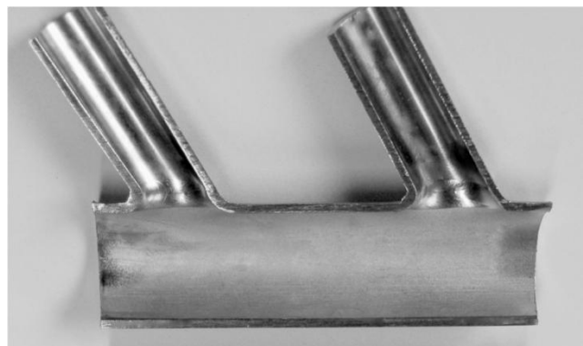
Abbildung 2: WIG-Innenorbitalschweißung mit anschließender Nahtnachreinigung
