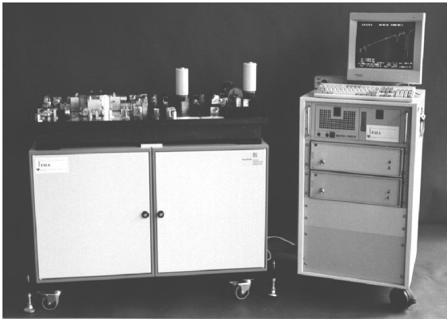
Abbildung 1: IRMA System: links – mobiler Optiktisch, rechts – Datenaufnahmeeinheit mit Laserkontroller und Computer
