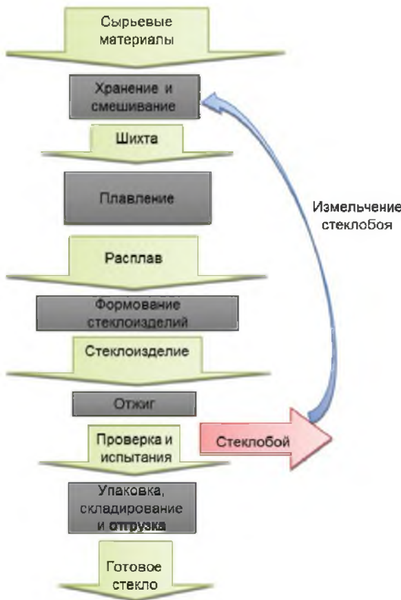
Рисунок 2 – Схема производства листового стекла
